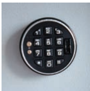
( E ) Elektronska brava EM3520, digitalni kod od 6 znamenki, moguća odgoda otvaranja, dva koda (upravitelj + korisnik), VdS klasa 2
